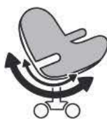
BASCULANTE EJE CENTRADO: El asiento y el respaldo se mueven siempre a la vez, manteniendo ambos siempre el mismo ángulo.
